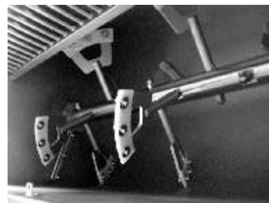
Lame in polizene alimentare per lo scarico e la pulizia totale della vasca
